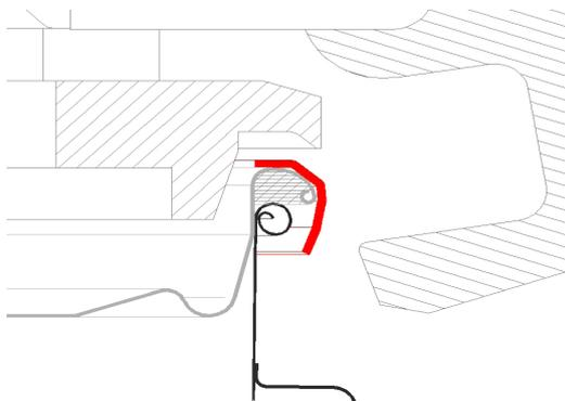
Im ersten Arbeitsgang wird der Deckel inklusive Spannring auf den Rumpf gelegt.
