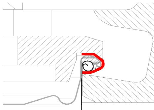
Im zweiten Arbeitsschritt wird die verwendete Verschlusseinheit mit dem TOPLock Werkzeug um die Bordierung des Eimers gepresst.
